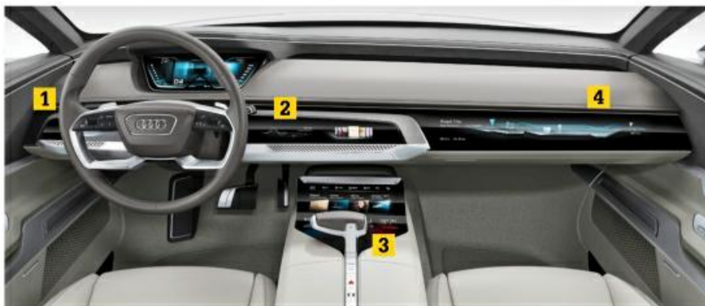
Disparition totale des boutons au profit d'écrans tactiles! A gauche du volant, les commandes d'éclairage et d'assistance à la conduite 1 . A droite, celles du système multimédia 2 . Sur la console centrale, un écran tactile flexible, escamoté à l'arrêt, se déploie à la mise en route et gère la clim', la saisie de texte et divers réglages du véhicule 3 . Enfin, l'écran donne accès à tout l'infodivertissement et permet même de configurer un itinéraire et de le transférer au conducteur d'un simple balayage du doigt 4 .
